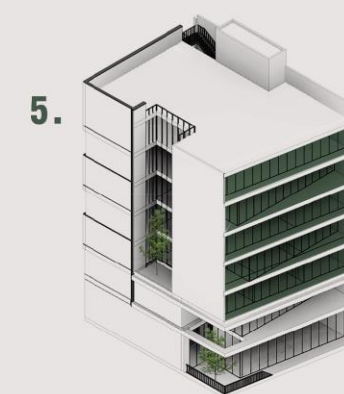
عقب نشینی پنجره های طبقات اداری به جهت کنترل ورود نور مستقیم جنوبی و ایجاد تراس در بخش های مختلف
