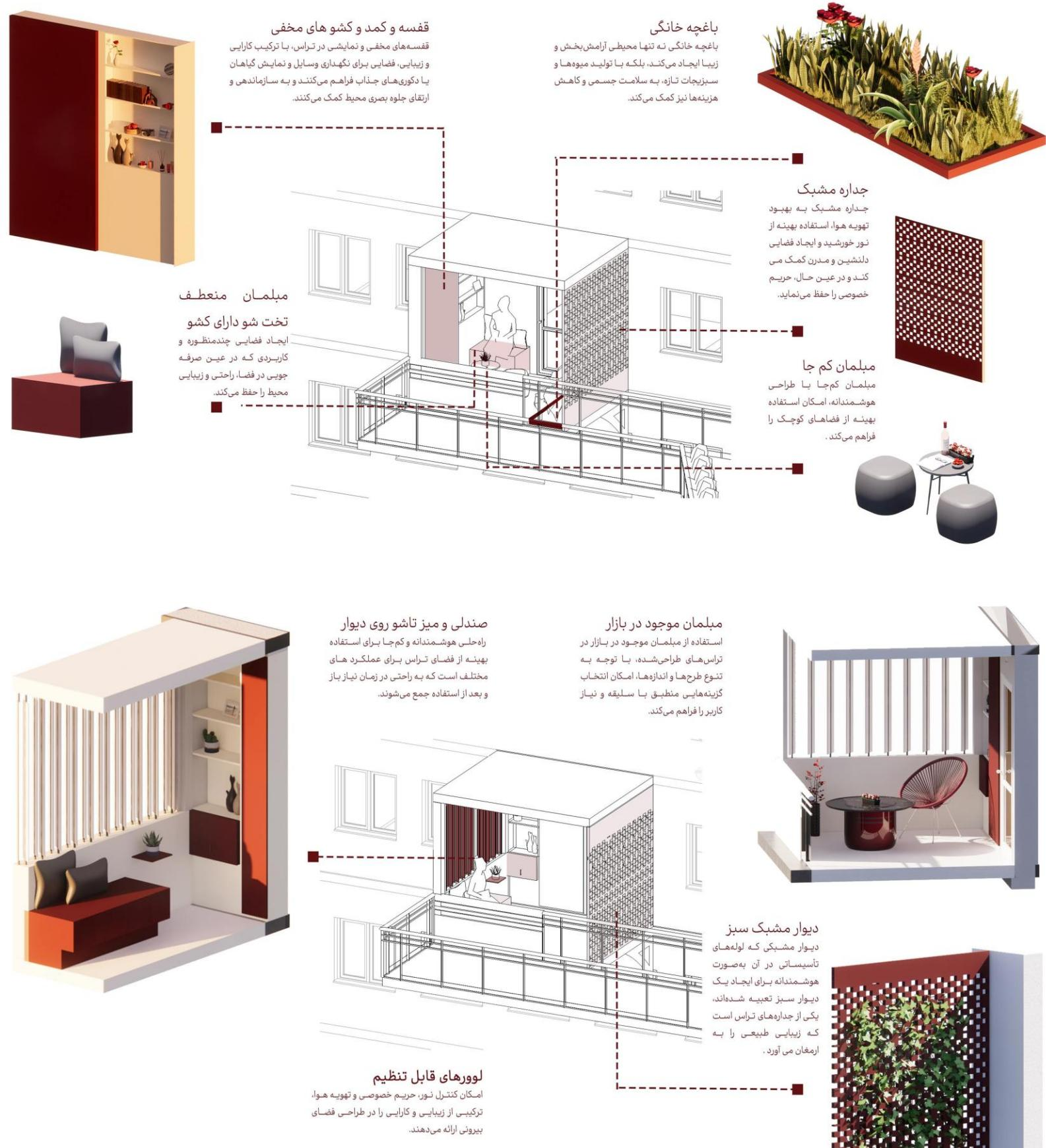
برای اتصال بالکن ها به نمای موجود، از المان های فولادی با اتصالات گیردار استفاده شده که امکان تحمل بارهای ثقلی و جانبی را فراهم می آورد. مگا کالمون نیز سازه ای فضاهای جمعی را بر عهده دارد.
